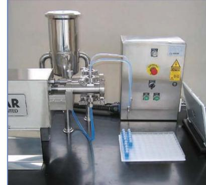
本装置适用于使用泵系统进行药液的填充。在泵的前端的单向阀，因采用了不使用密封圈的密封结构，分解清洗相当的容易。填充精度可在 $\pm 1\%$ 以下的高精度。
