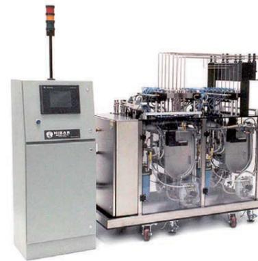
本装置为多种类墨水(4-8色)彩色打印机充填墨盒所设计的装置。
