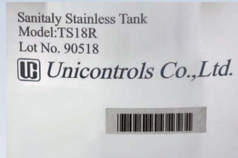
激光标记是通过激光的照射，使其表面变质、融化、蒸发从而起到将文字、记号、等直接刻印加工在被加工物上。
