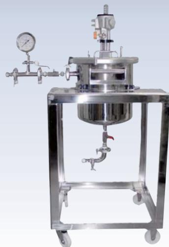
带容器夹套型高卫生级加压器
